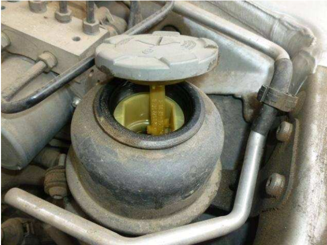
COMPROBACION DEL CORRECTO NIVEL DEL LIQUIDO DE DIRECCION
